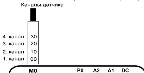
Датчики, объединенные в один коннектор и датчики с собственным питающим напряжением являются взаимосвязанными и должны быть эл. изолированы. Напряжение в самих измерительных входах не должно превышать 5 вольт (между В, С, D, А и -).
