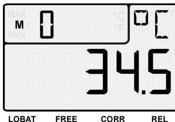
Измеренное значение отображается в основном поле с соответствующей единицей измерения, измерительная точка отображается в функциональном поле. Все специальные рабочие статусы измеренного значения, отображаются во вспомогательной секции.
