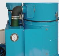
Ручка для перемещения и бугель для транспортировки контейнера с помощью погрузчика или крана.
