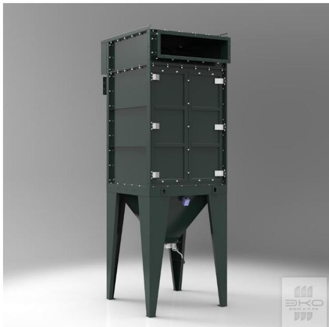
Картриджные фильтры с импульсной продувкой по сравнению с рукавными имеют более высокую эффективность очистки, **но при этом не могут эксплуатироваться в условиях высокой входной запыленности.** Максимальная концентрация пыли на входе в фильтр составляет около 5 г/м<sup>3</sup>. Картриджные фильтры применяются в таких технологических процессах как лазерная и плазменная резка металлов, сварка, фасовка сыпучих материалов, порошковая окраска и др.
