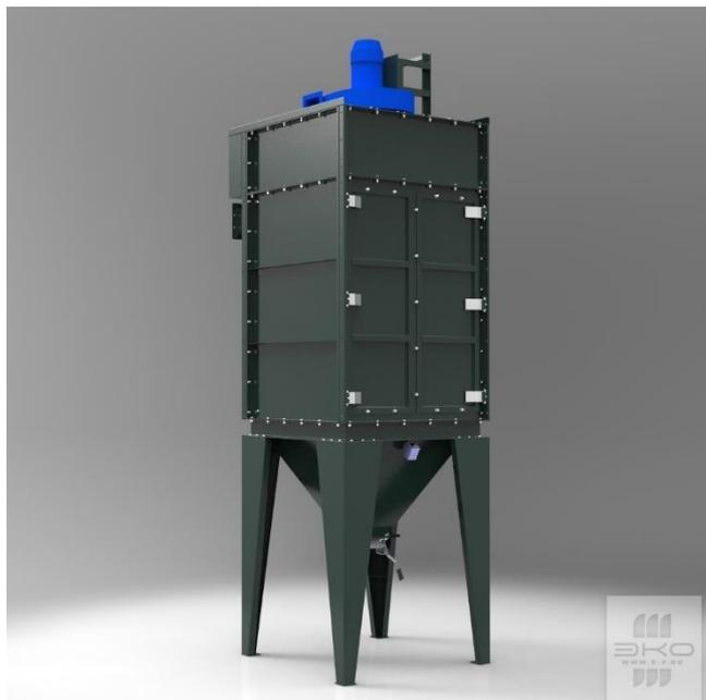
В отличие от стационарной системы аспирации, установка фильтровентиляционных агрегатов не требует проектных и монтажных работ, которые, как правило, стоят дороже самого оборудования. Благодаря компактности фильтровентиляционные агрегаты могут быть установлены в цеху рядом с технологическим оборудованием.
