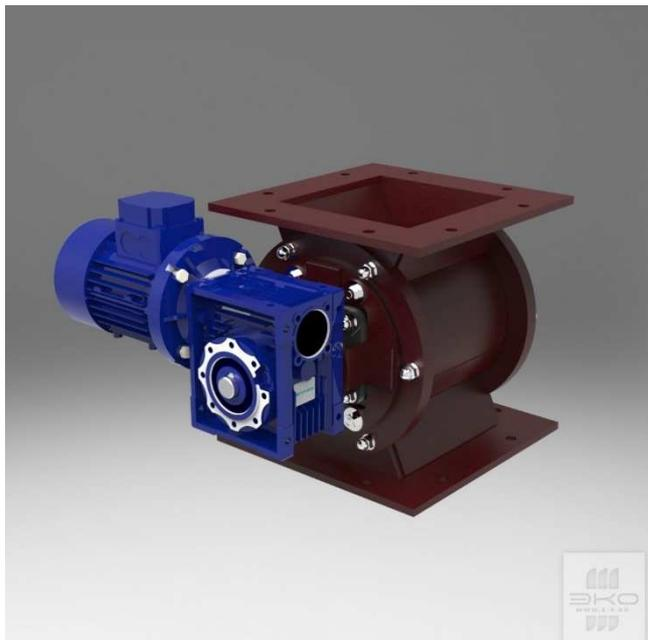
Шлюзовой затвор используется для разгрузки бункеров, силосов, рукавных фильтров и другого оборудования, находящегося под разрежением или избыточным давлением. Шлюзовой затвор (шлюзовой перегрузчик, шлюзовой питатель) обладает герметичностью, обеспечивающей минимальную утечку воздуха из технологического оборудования.
