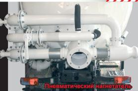
Для транспортировки и подачи сыпучих и дробленых материалов на высоту до 50 м (загрузка силосов, вакуумная перегрузка гравия, доставка сыпучих материалов на верхние этажи и кровлю зданий). DN 125
