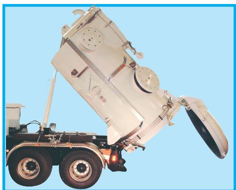
**Прямая выгрузка** через разгрузочный люк с гидравлическим приводом DN 1900 мм.
