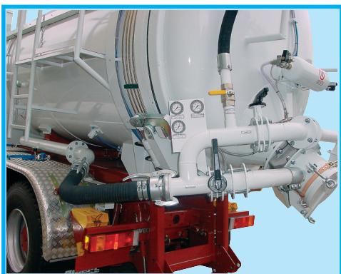
Для транспортировки и подачи сыпучих и дробленых материалов на высоту до 50 м (цемент при загрузке силосов, шунгизит, щебень)
