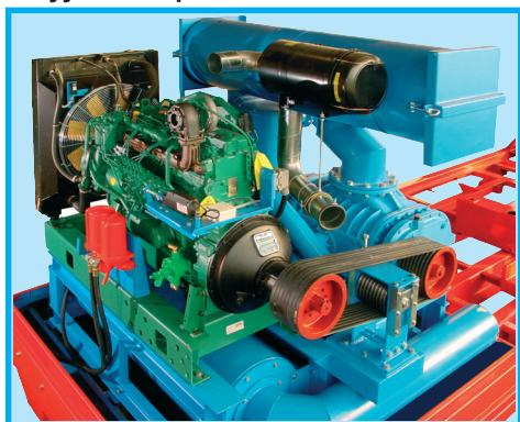
Не требующий обслуживания, стойкий к резким изменениям предельных нагрузок, ротационный вакуумный насос с приводом от дизельного двигателя 81-240 кВт.
