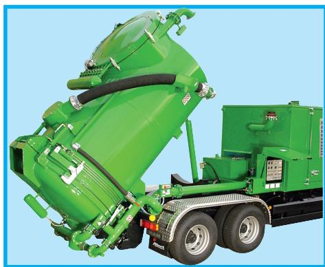
Угол наклона сборного бункера оптimalен для выгрузки густых и вязких материалов. При выгрузке бункера автоматически удаляется пыль, оседаемая в камере основного фильтра.
