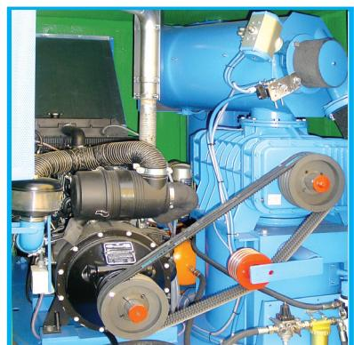
Силовой отсек с ротационным вакуумным насосом и дизельным двигателем. Системы защиты вакуумного агрегата от перегрева, перегрузки и повреждения основного фильтра. Легкий доступ для технического обслуживания.
