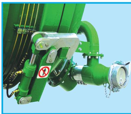
Разгрузочный люк с гидравлическим приводом и пневматический нагнетатель DN 125 мм. Надежная и продуманная конструкция гарантирует эффективность эксплуатации.
