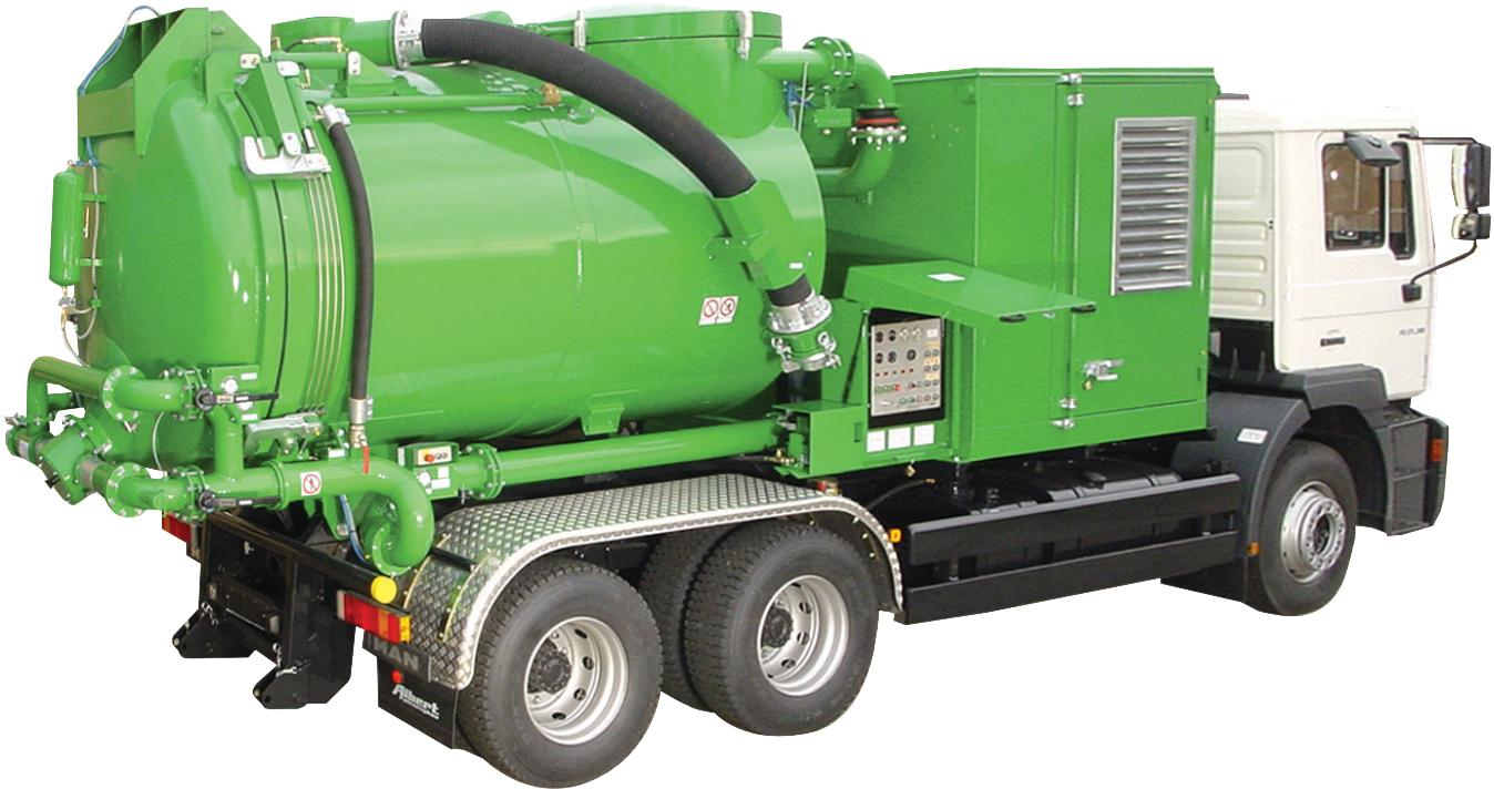
**BlowVac 4000 Diesel** - самый компактный агрегат в семействе **BlowVac**, обладающий всеми достоинствами мощных систем: Всасывание, Пневматическая транспортировка материала, Выгрузка бункера под наклоном через разгрузочный люк с гидравлическим приводом. Применяется для сбора и транспортировки сухих сыпучих материалов и жидкостей. Для работы с опасными отходами и взрывоопасной пылью разработано оборудование с защитой от взрыва стандарта **ATEX**.
