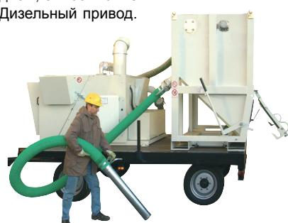
Вакуумные агрегаты **VacTrailer** серии **S** оснащаются ротационным вакуумным насосом – 500 мбар, с системой воздушного охлаждения, обеспечивающим силу всасывания, достаточную для сбора хорошо перемещаемого материала **на расстоянии до 100 м от точки всасывания** по гибким шлангам диаметром 80 или 100 мм.
