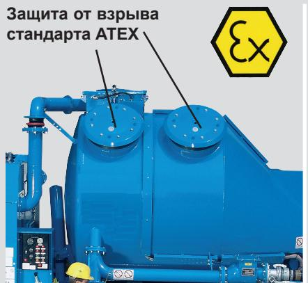
**EVN** - Клапан сброса избыточного давления взрыва с пламегасителем (не разрушается при взрыве и может использоваться многократно).
