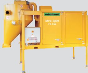
Стационарная рамная конструкция вакуумного агрегата. Электрический привод 75 кВт, либо автономный дизельный привод 84 кВт. Ротационный вакуумный насос, макс. вакуум 500 мбар. Система пневматической очистки фильтра AirShock®. Мощность всасывания макс. 3800 м<sup>3</sup>/ч. Диаметр всасывающего патрубка 125 мм.
