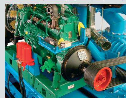
Привод вакуумного насоса
