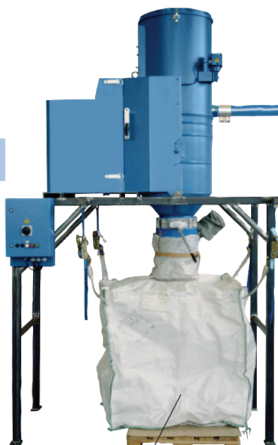
Выгрузка в мешки Биг-Бэг. Собранный материал упакован в мешки и готов для транспортировки.
