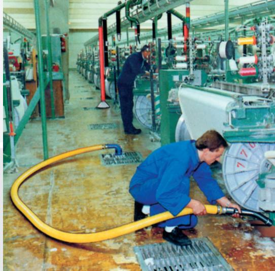
Вакуумные розетки, расположенные на расстоянии 10 м друг от друга, позволяют комфортно работать с короткими шлангами. Чистку можно производить при работающем оборудовании.
